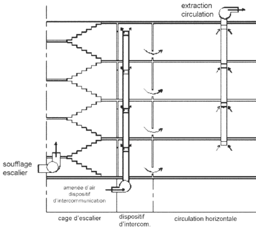
Figure 3c : Solution B. – Emplacement des ventilateurs
