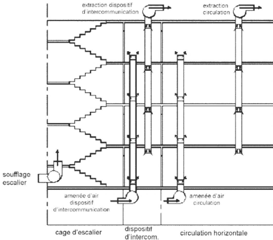
Figure 2d : Solution A. – Emplacement des ventilateurs.
