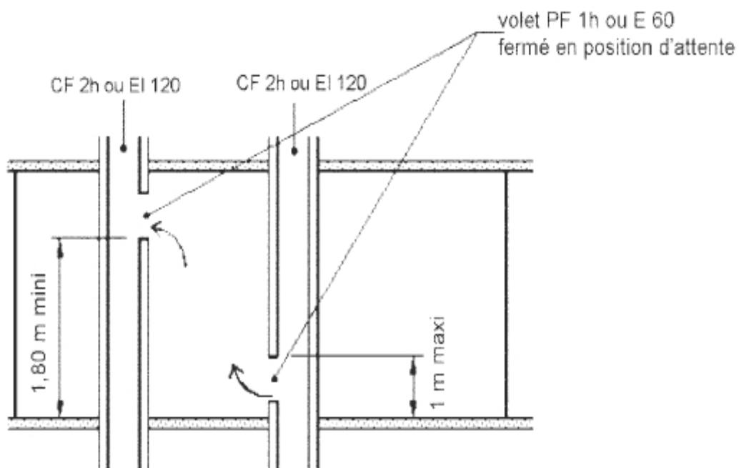
Figure 2c : Solution A. – Coupe dispositif d'intercommunication
