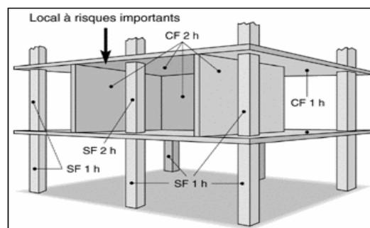
**Résistance au feu des structures et planchers d'un local à risques importants.**
