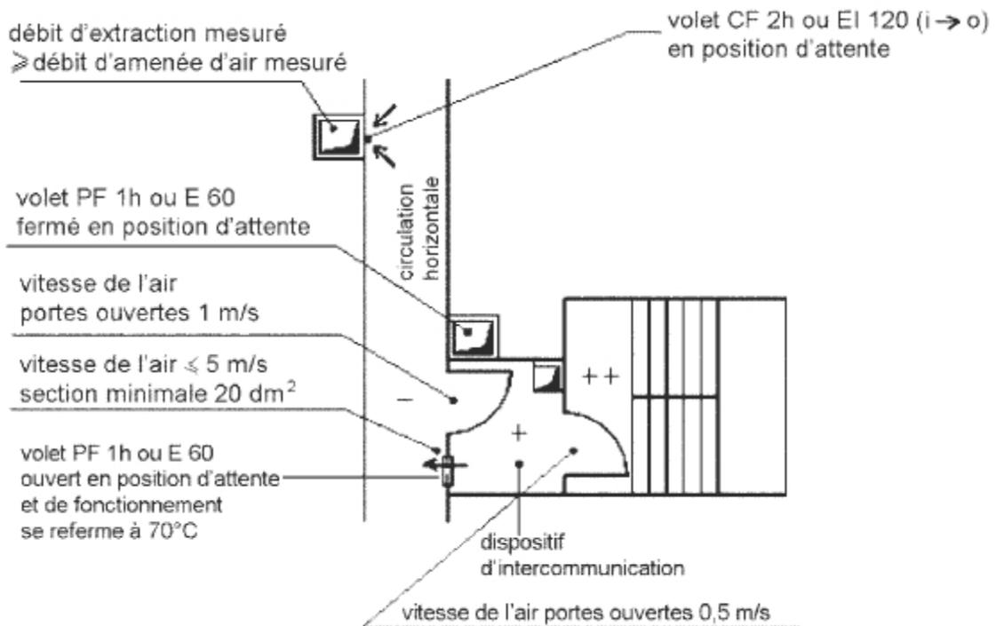
Figure 3a : Solution B. – Principales caractéristiques
