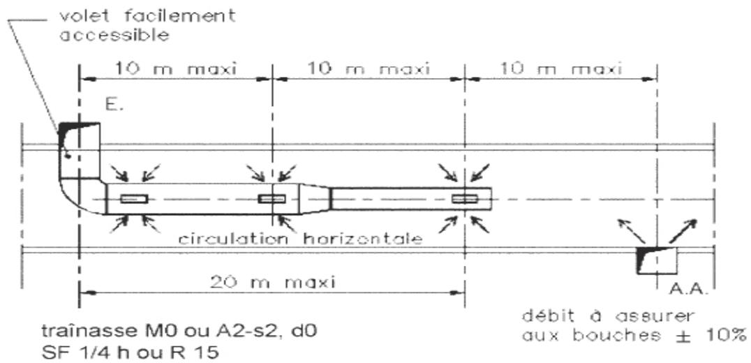
Figure 1d : implantation des bouches d'amenée d'air et d'extraction dans les circulations horizontales, extraction par trainasse en plafond.
