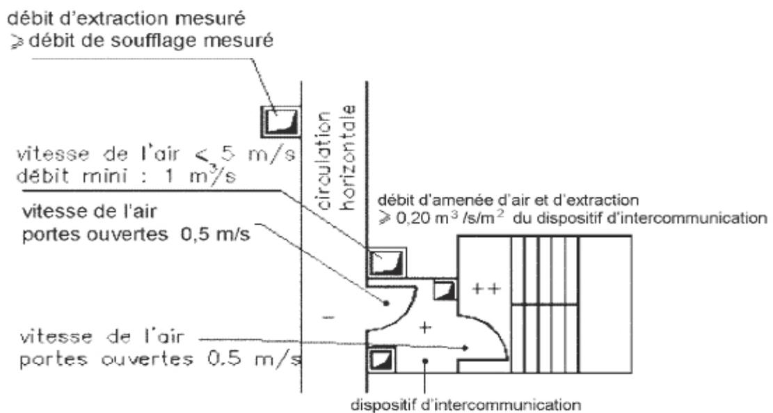
Figure 2a : solution A. – Principales caractéristiques.
