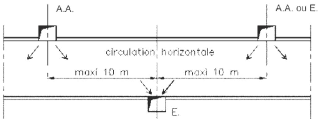
Figure 1a : implantation des bouches d'amenée d'air et d'extraction dans les circulations horizontales.
